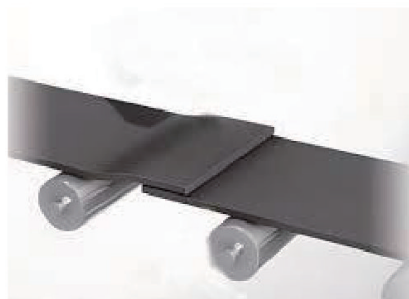
橡胶带的接缝检测
