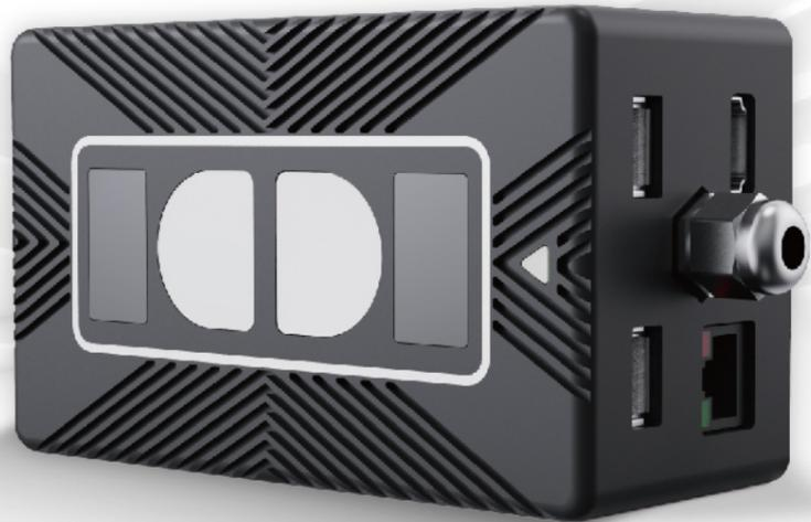
DM-X 是一款工业级iToF RGBD 智能相机。提供640\*480分辨率, 毫米级测量精度及5米测量距离, 广泛应用于机械臂、AGV 叉车、低速无人车、智慧物流、智慧农业等行业, 适用于抓取引导、目标识别、避障、监测、安全区域防护等场景。
