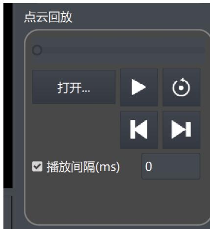
首先需要选择指定的数据文件夹，单击“打开”按钮，确认存储数据的文件夹，选中正确的文件夹后，会统计读取到的点云文件数量，如下图所示：
