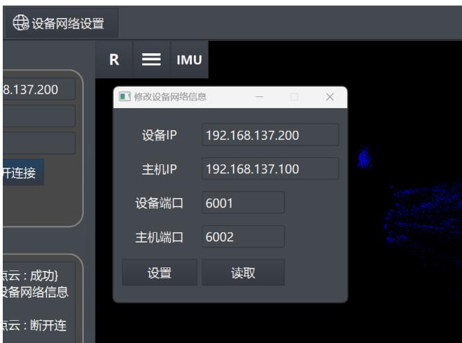
根据需要设置对应的IP、端口，点击“设置”按钮下发当前的网络信息。
