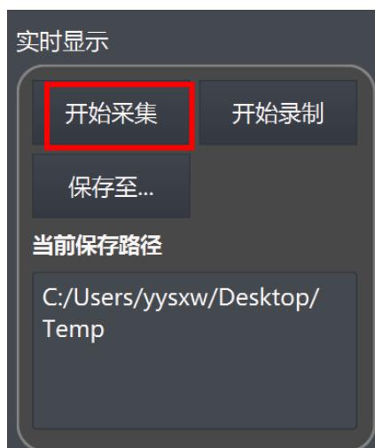
单击“实时显示”面板的“开始采集”按钮，开始传输设备的实时数据，显示到主窗口中。
